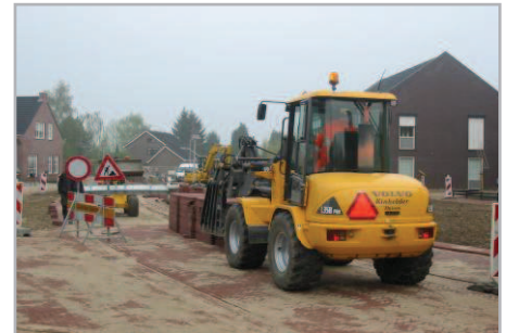
Midshovel 6,2 ton | Rolbezem 194,00 cm breed | Stenenklem
