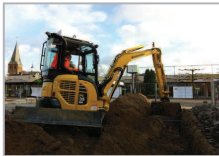
Rupskraan 4,0 ton | Binnendraaier 174,00 cm breed | Overdruk | Sorteerknijper
