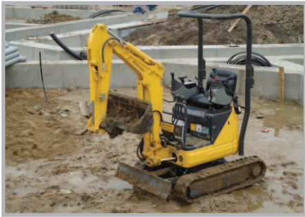
Rupskraan 1,0 ton | Binnendraaier 75,00 cm breed
